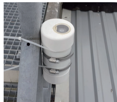
Dit kleine meterkastje hangt in de haven van Lauwersoog en meet hoe donker het is.
